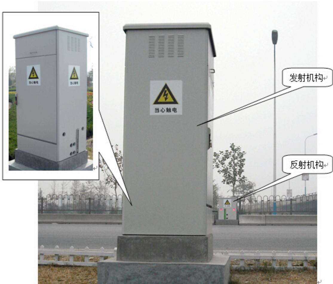
图 3.2 固定式机动车尾气遥测系统（道边发射与反射机构）
