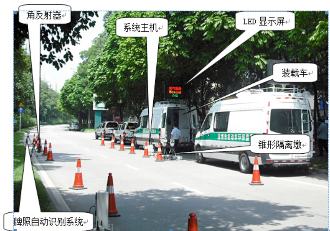
图 3.15 移动式机动车尾气遥感监测车调试现场
