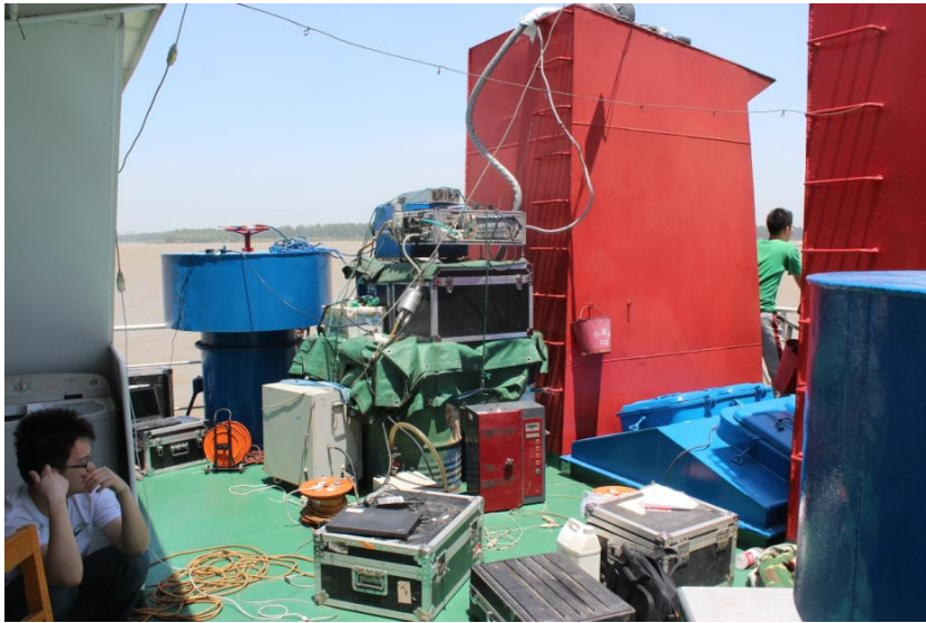
图 2.13 排气分析仪和排气流速测量仪实物测试图
