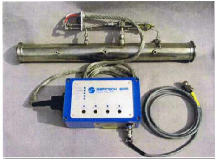
图 2.3 EFM2 尾气质量流量计外观图
