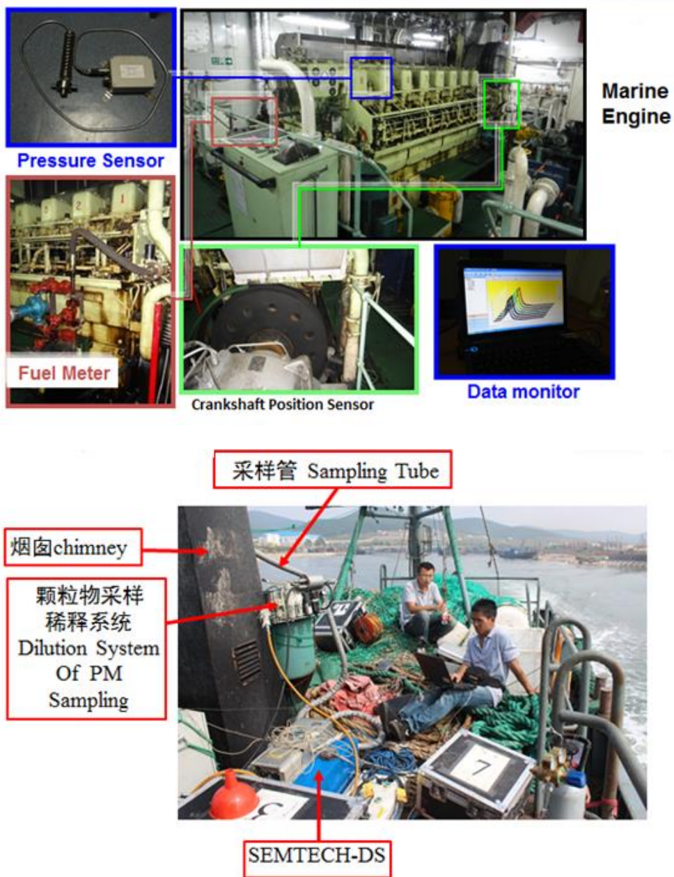
图 2.12 使用排气分析仪和油耗仪的实物测试图
