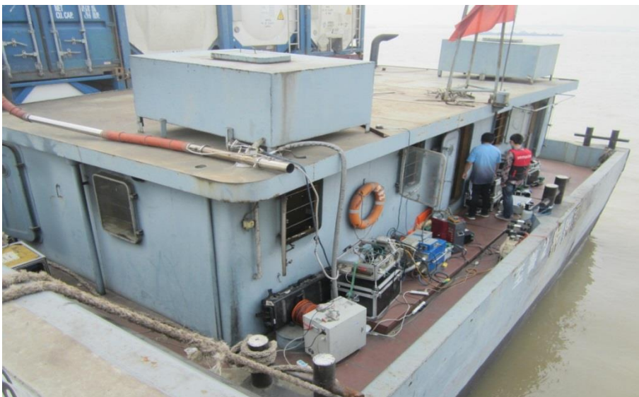
图 2.10 集装箱船测试仪器安装实物图
