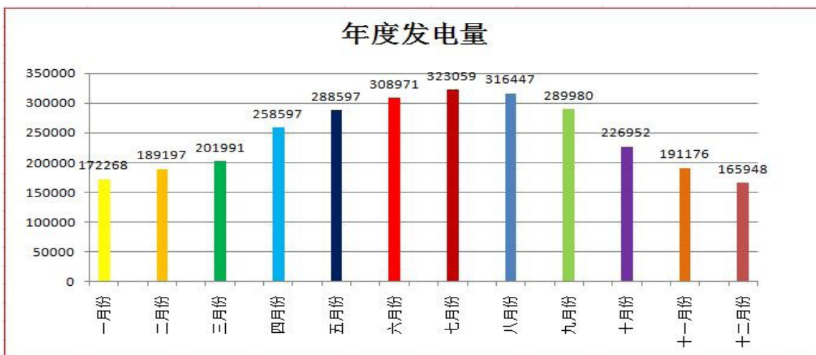
图 87 锦虹光伏发电项目 2013 年度发电量统计
