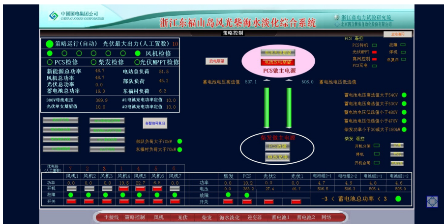
图 82 双向变流器作为主电源时的蓄电池放电阶段
