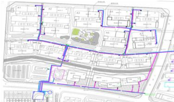
综合管沟总体布局示意图
