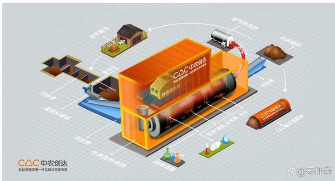
图 7-7 中农创达“奶牛粪转化牛床垫料整体解决方案”技术原理图
