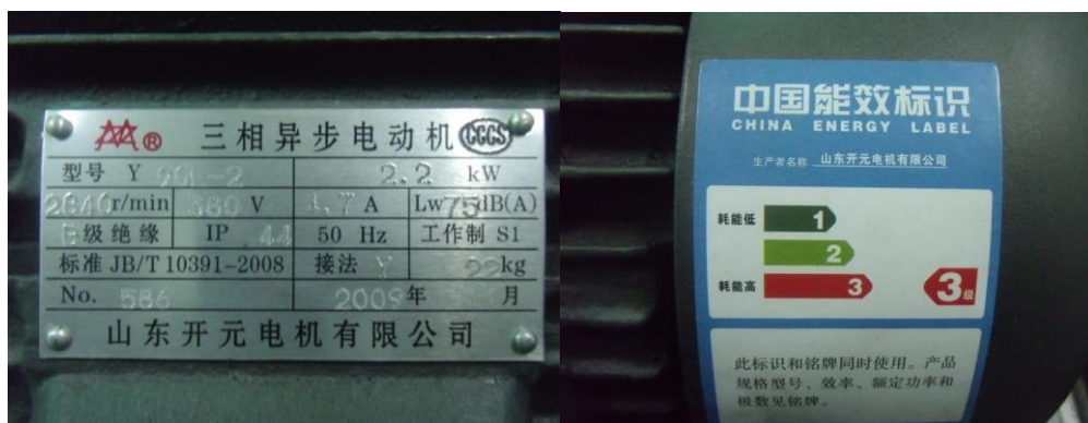
图 6-11 某电机产品能效标识和产品铭牌
